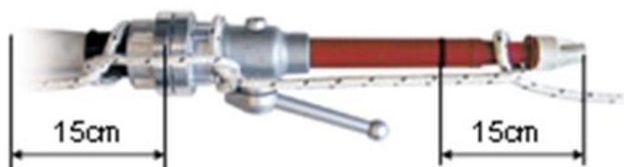
ganzer Schlag und halber Schlag am Strahlrohr
